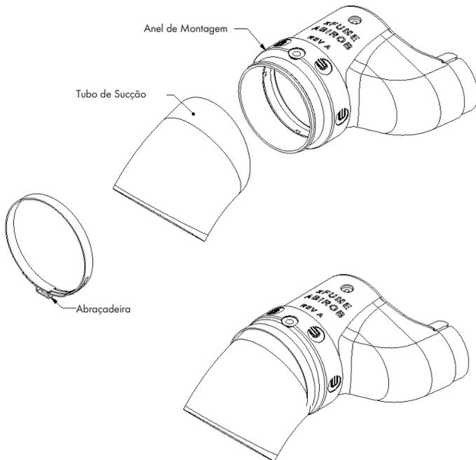
Nota: se o tubo de sucção não parece estar mais ou menos concêntrico com o pescoço, pode ser devido ao fato de o tubo ter sido instalado ao contrário. Tente colocar a extremidade oposta do tubo no anel de montagem. Se o tubo ainda não estiver concêntrica, tente inclinar o tubo sobre o anel, se necessário, antes de prender.
